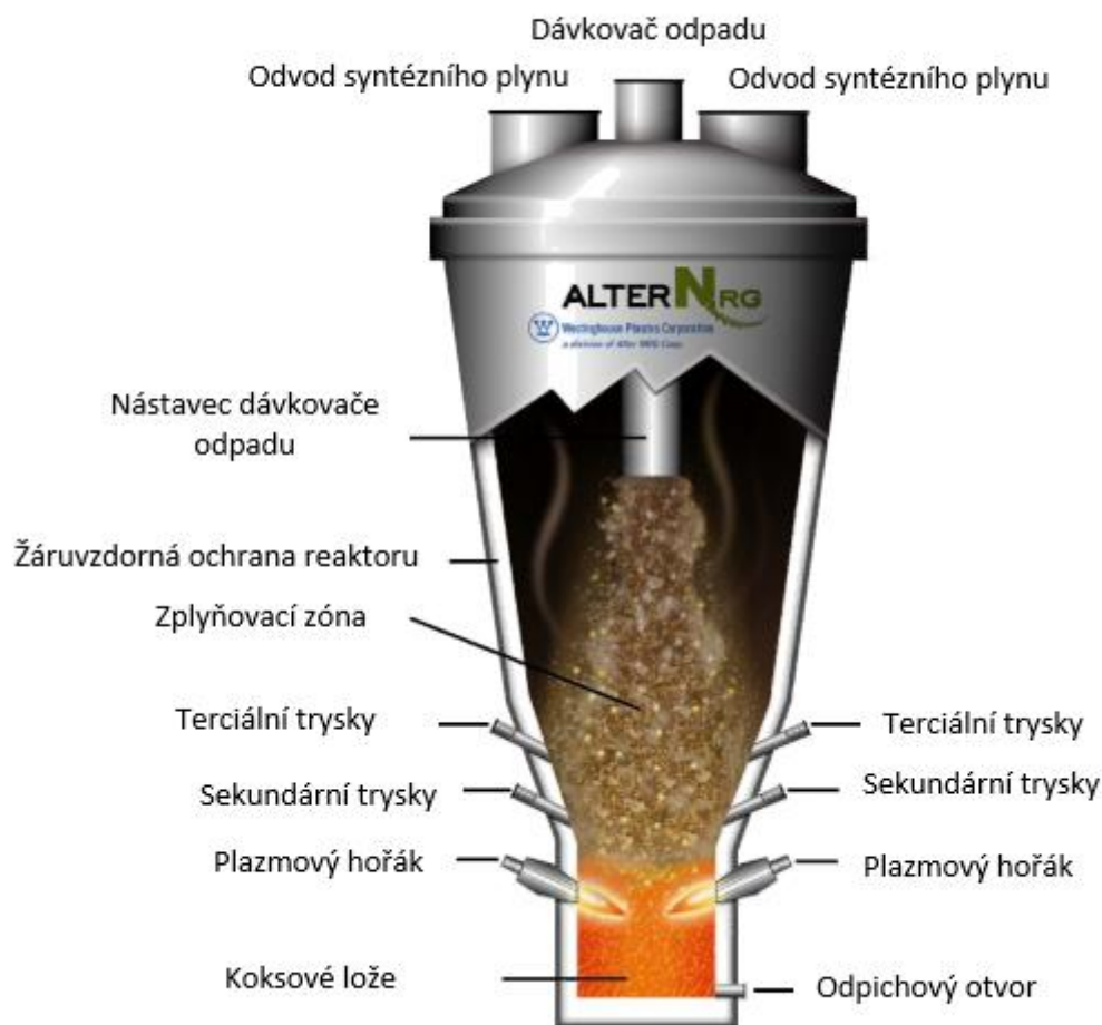
Obrázek 16 Upravený design reaktoru na základě zkušeností z Eco Valley [36]
